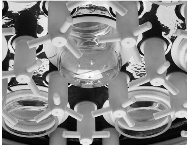
Abb. 5: Flüssigkeitssammler und Wiederverteiler mit Verteilertassen (Ansicht von unten)
