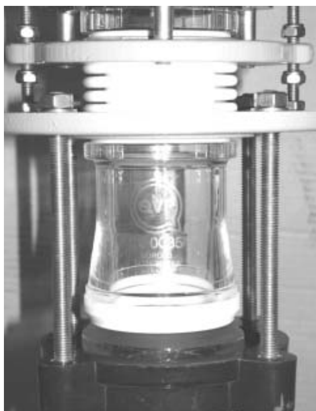
Abb. 6: Übergangsstück aus Glas mit KRT
