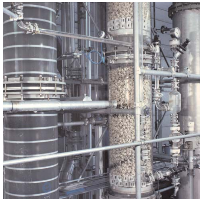
Abb. 1: Siebbodenextraktionskolonne und Rektifikation DN450
