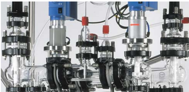
Abb.1: Settler mit höhenverstellbarem Überlauf (links), Mixerkopf (rechts)
