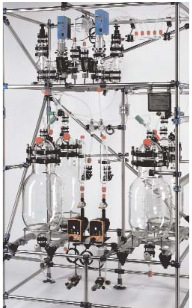
Abb.2: Zweistufige Mixer Settler-Apparatur DN 50
